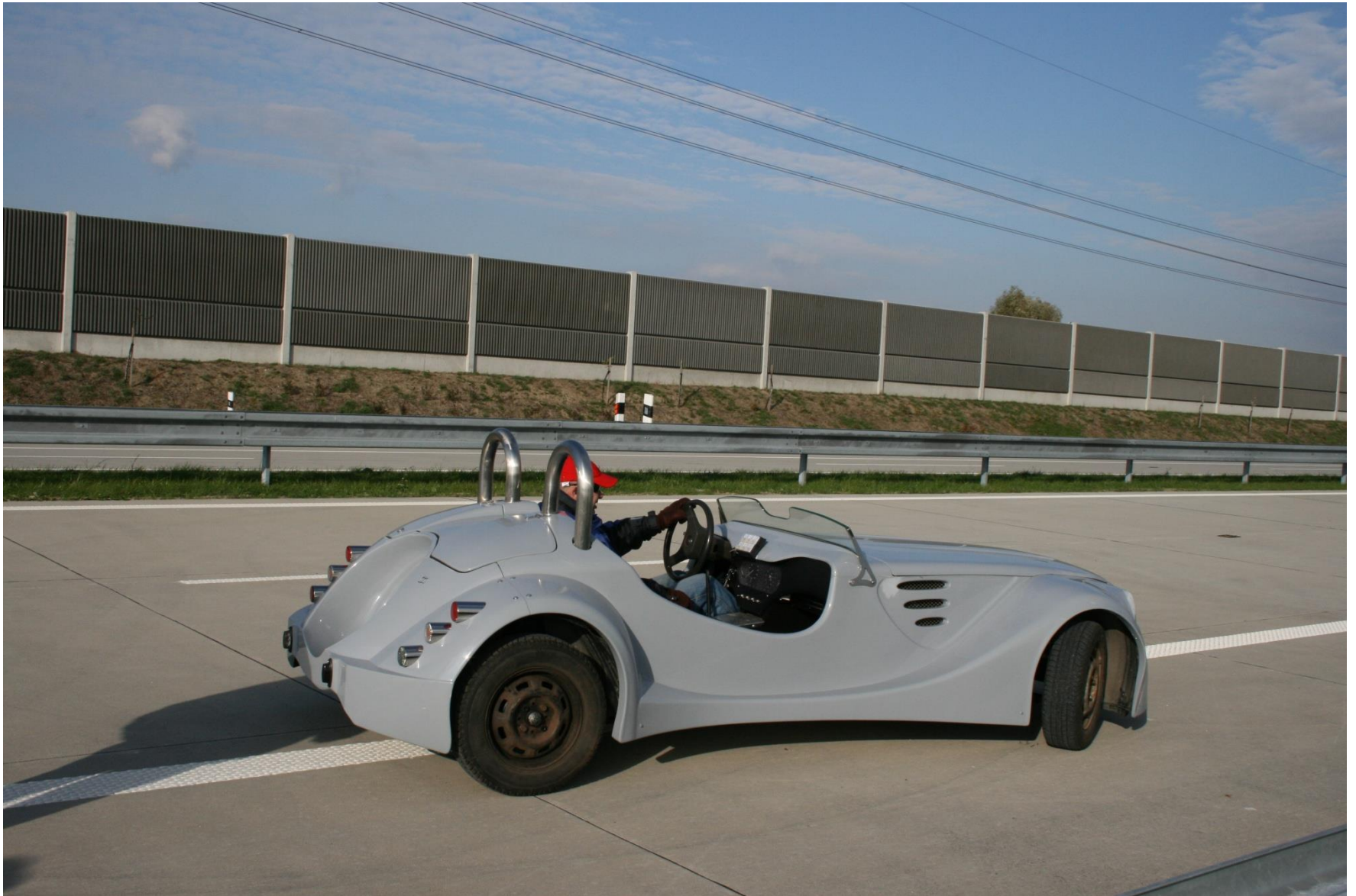
Experimentální elektromobil KAIPAN VoltAge K3 2012 (sériová hybridizace pomocí jednotky prodloužení dojezdu s vodíkovým palivovým článkem).
